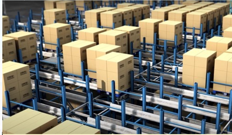
Automatische palletopslag - compact
